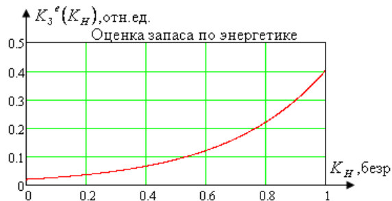
Рис. 2. Зависимость коэффициента запаса K_3^e по энергетике от уровня новизны проектируемого модуля K_H
