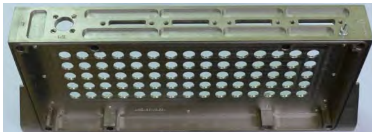
Рис. 4. Деталь после высокоскоростной механической обработки.
