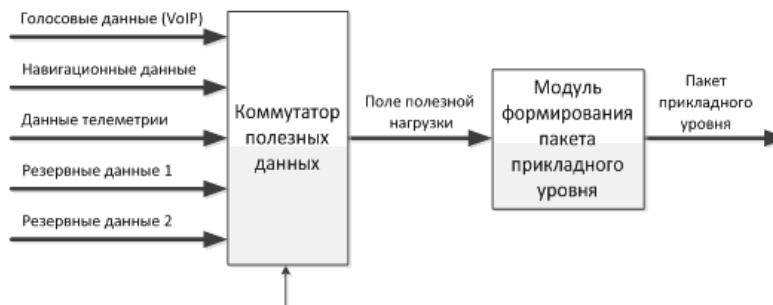
Рис 3. Устройство формирования пакета единой передачи разнородных типов данных
