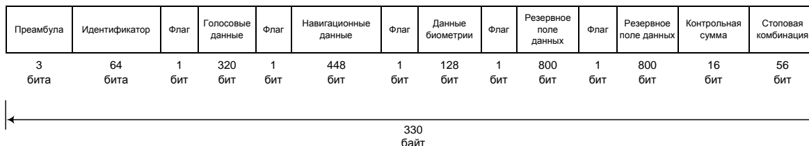
Рис 2. Структура пакета протокола прикладного уровня
