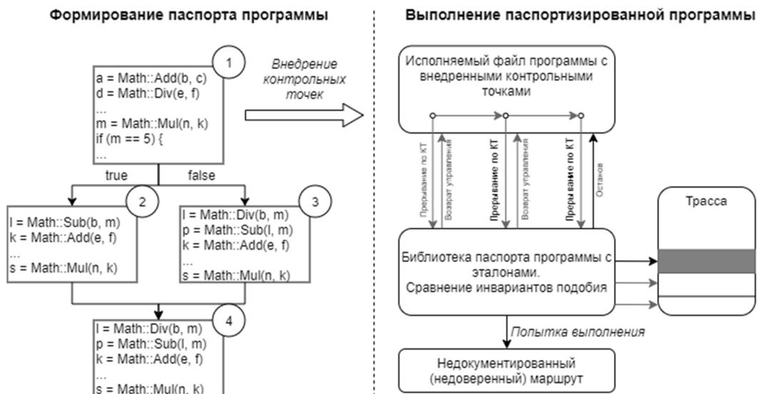
Рис. 2. Механизм контроля паспортизированного вычислительного процесса
